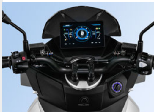
■ Ecrã central TFT a cores com 5 níveis de luminosidade (STORM-X+ & STORM-X 150)
