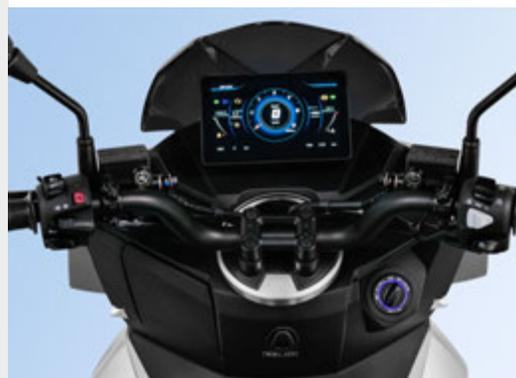
■ Display centrale TFT a colori con 5 livelli di luminosità (STORM-X+ & STORM-X 150)
