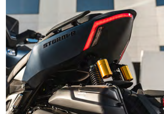
■ Depósito de gás separado (STORM-R +)
