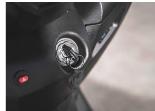
■ Sistema de cierre con bloqueo y apertura del asiento
