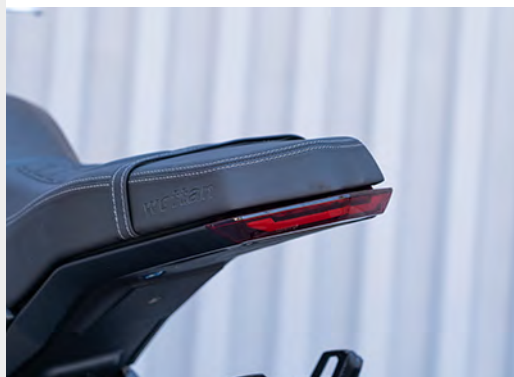
■ Conjunto de luces LED
