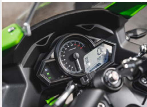
■ Strumentazione con orologio analogico e display digitale
